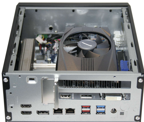
Shuttle XPC slim Barebone XB860G2 mit eingebauter leistungsstarker Grafikkarte
