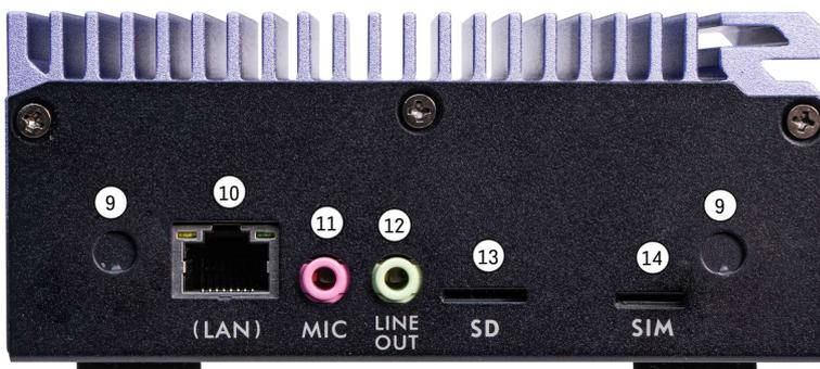
9. 2x Perforation für externe WLAN-Antenne
