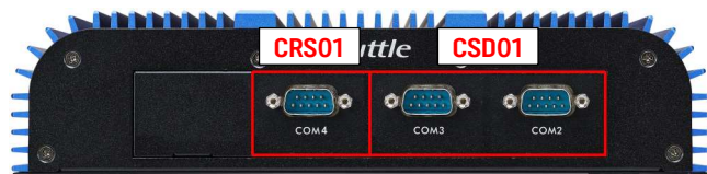
The front panel with 3 additional COM ports. Die Vorderseite mit 3 zusätzlichen COM-Ports. La face avant avec 3 ports COM supplémentaires.
