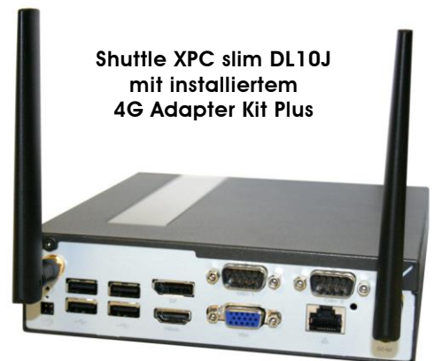
4G Antennen mit Kabeln
