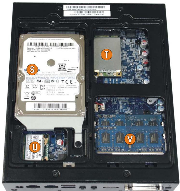
\*) Das WLAN-Modul gehört in Form einer Mini-PCIe-Steckkarte zum Lieferumfang des Barebones. Andere Komponenten wie Festplatte, SSD, Speicher, weitere Mini-PCIe-Steckkarte oder mSATA-Modul sind nicht enthalten.
